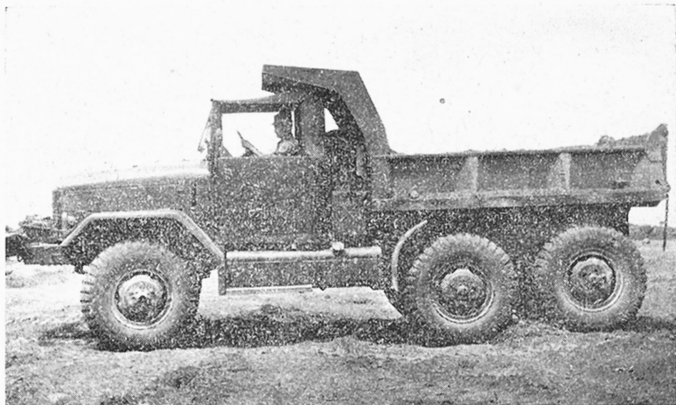
Figura 12 — Volqueta de 2½ toneladas 6 X 6 M47
